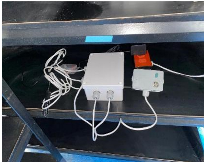
Figura 8. Módulo de adquisición de variables ambientales instalado en cultivo del Gimnasio Campestre Marie Curie
